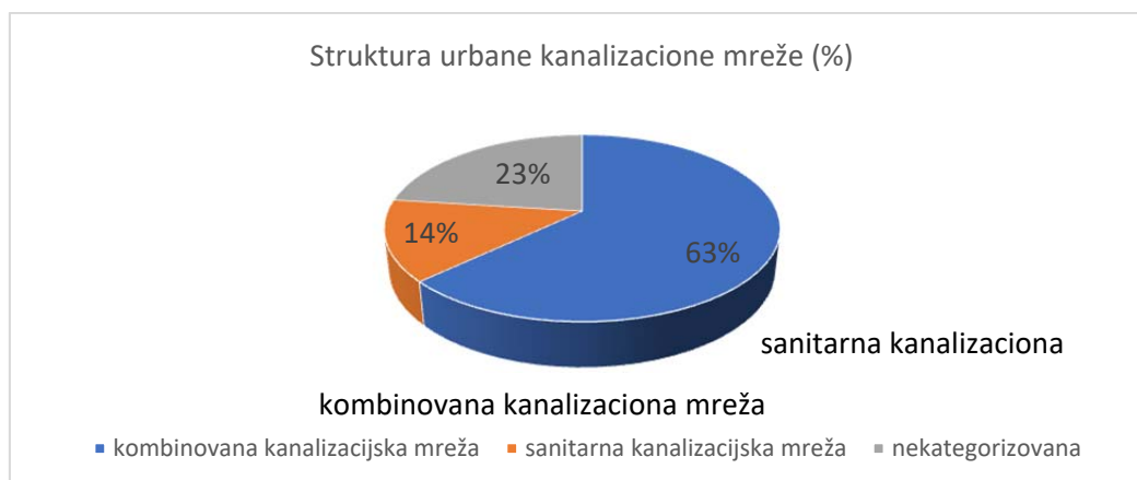
Slika 3: Struktura urbane kanalizacione mreže
